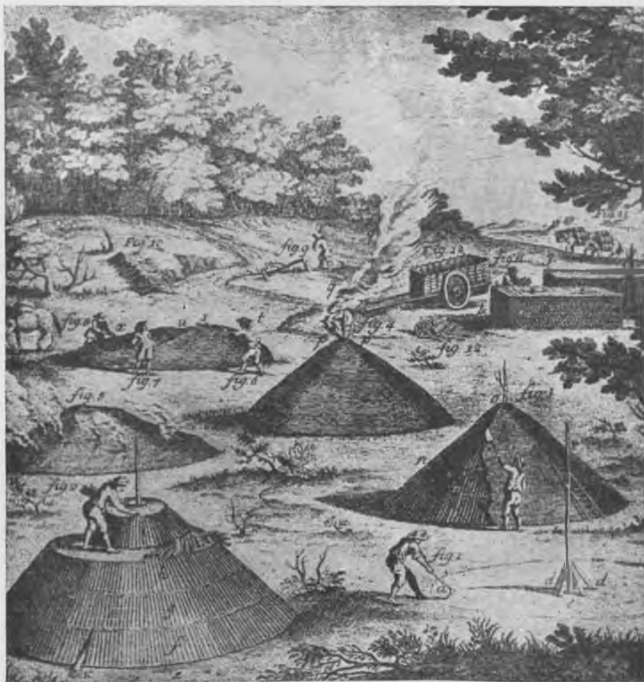
„Kurzenie węgla”, czyli wypalanie węgla drzewnego, było jedną z najtrudniejszych czynności starodawnego hutnictwa. 2, 3 doby musiało się tlić drewno oblepione umiejętnie trawą i gliną, pod czujnym nadzorem węglarzy. Sztych z książki Sztuka węglarska , wydanej w Warszawie w 1769 r.
